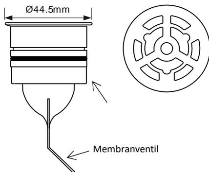
Das Whiffaway-Ventil, basierend auf einer patentierten Membrantechnologie, garantiert ohne den Einsatz von Strom, Sperrflüssigkeit oder anderer Zusätze den optimalen, geruchsfreien Abfluss. Die sichere Methode, den Verbrauch von Trinkwasser in Urinalen zu vermeiden und dadurch die Umwelt zu entlasten.
