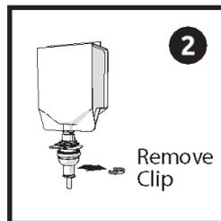
Nehmen Sie den Nachfüllbeutel aus der Schachtel. Entfernen Sie den roten Clip, indem Sie ihn zur Seite schieben. Legen Sie den Nachfüllbeutel mit der Düse nach unten in den Spender.
