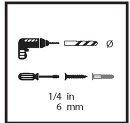
Verwendung der Bohrschablone aus dem Spenderkarton. Bohren Sie Löcher in die Wand mit einem 6-mm- oder "1/4"-Bohrer, an dem der Spender montiert werden soll. Entfernen Sie die Schablone und richten Sie die Löcher in der Rückplatte des Spenders an den vorgebohrten Löchern aus. Schrauben und Anker sind im Lieferumfang enthalten, um den Spender an der Wand zu befestigen.
