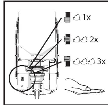
Verwenden Sie zum Einrichten des Dosiersystems den schwarzen Schalter am Getriebe.
