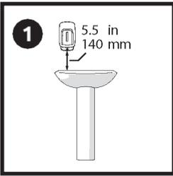
Der Spender sollte 140 mm (5,5 Zoll) über der Arbeitsplatte, dem Waschbecken oder einer anderen Oberfläche montiert werden.
