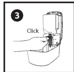
Setzen Sie den Beutelstecker in die U-förmige Halterung ein, um sicherzustellen, dass die Düse in den Betätigungshebel passt. Klicken.
