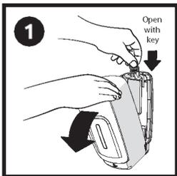
Verwenden Sie den Spenderschlüssel, um die vordere Abdeckung zu öffnen. Führen Sie den Schlüssel in die Löcher oben am Spender ein, drücken Sie den Schlüssel und ziehen Sie die Abdeckung zu sich hin. Die Abdeckung ist unten am Spender angelenkt.
